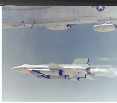
DUE TO THE EXTREME HEAT, HYPERSONIC AIRCRAFT TYPICALLY USE SUPERSONIC-COMBUSTION RAMJET OR 'SCRAMJET' ENGINES
