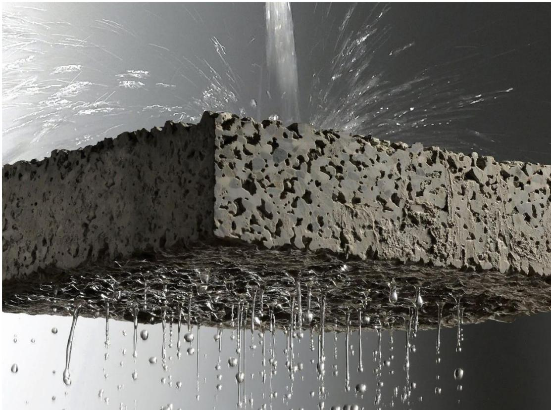
Exemplo de como funciona o concreto permeável e seu sistema de drenagem
