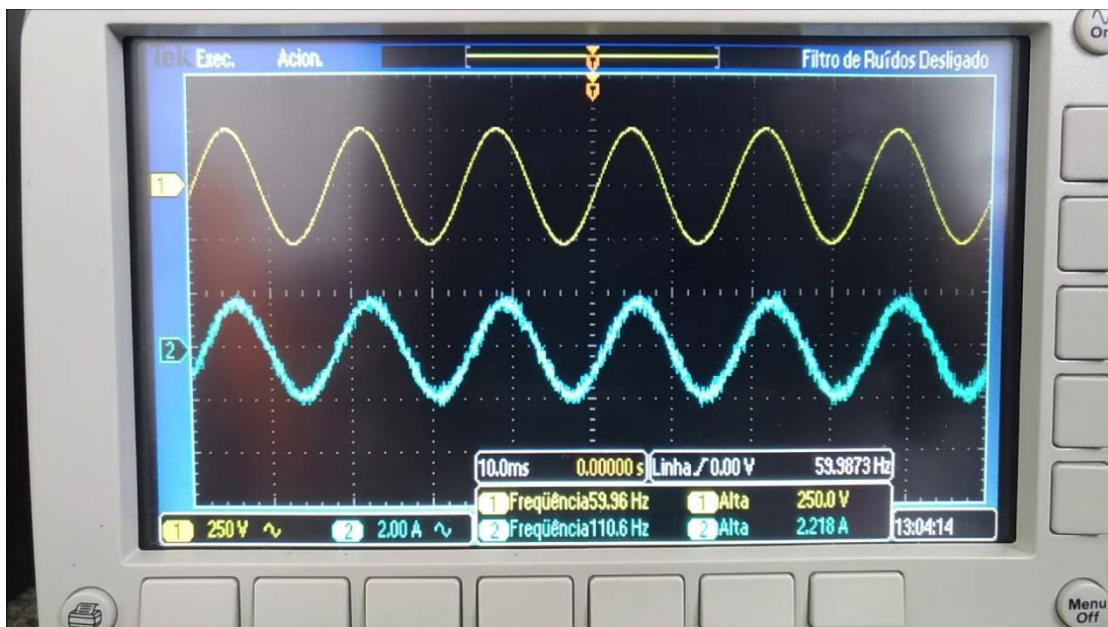
Inversor fotovoltaico conectado à rede elétrica com variação da tensão. Fonte: YouTube
