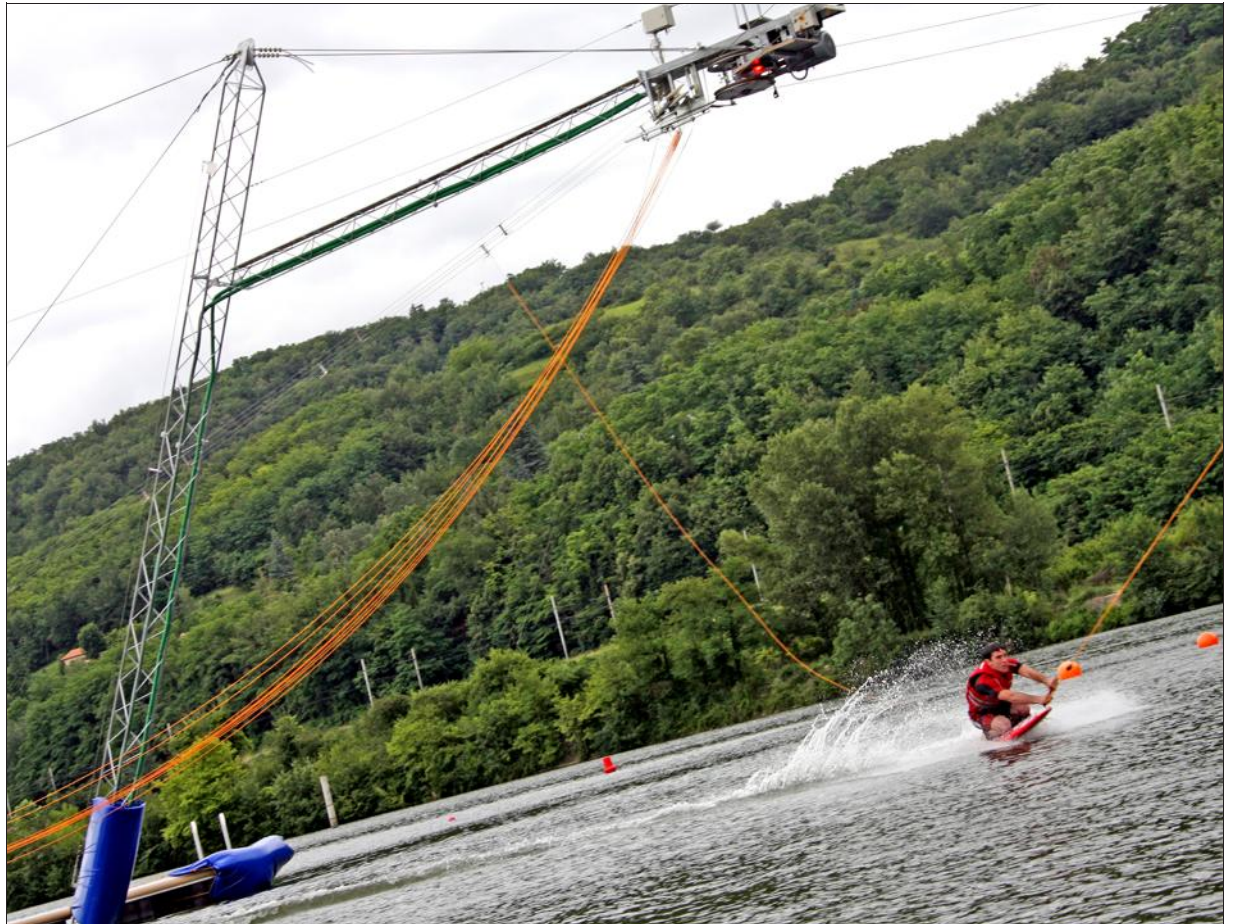
■ La traction se fait par un système de câbles entraîné par un moteur électrique autour de cinq pylônes. Photo Richard MOUILLAUD
