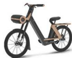
↑ Le modèle (à venir) *e-Solex 3800*, moteur 500 W, batterie amovible 672 Wh, vitesse max. 45 km/h, autonomie 30 km.
