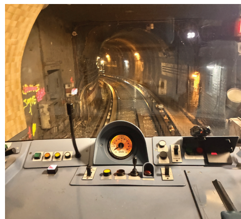
Photo de Sacha Ledran Lewin, Gaspard Denurra. Partie centrale de la cabine avec les différents boutons, le micro, la manette de gaz et la vitesse
