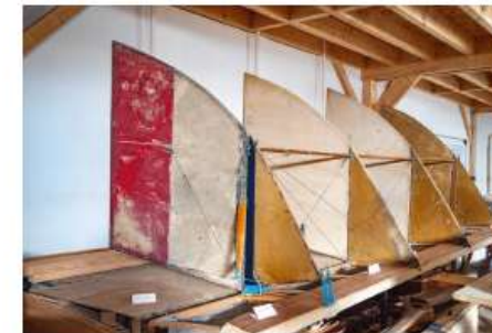
La queue du Caudron G4, atypique avec ses quatre dérives qui portent encore leur toile de lin d'origine.
