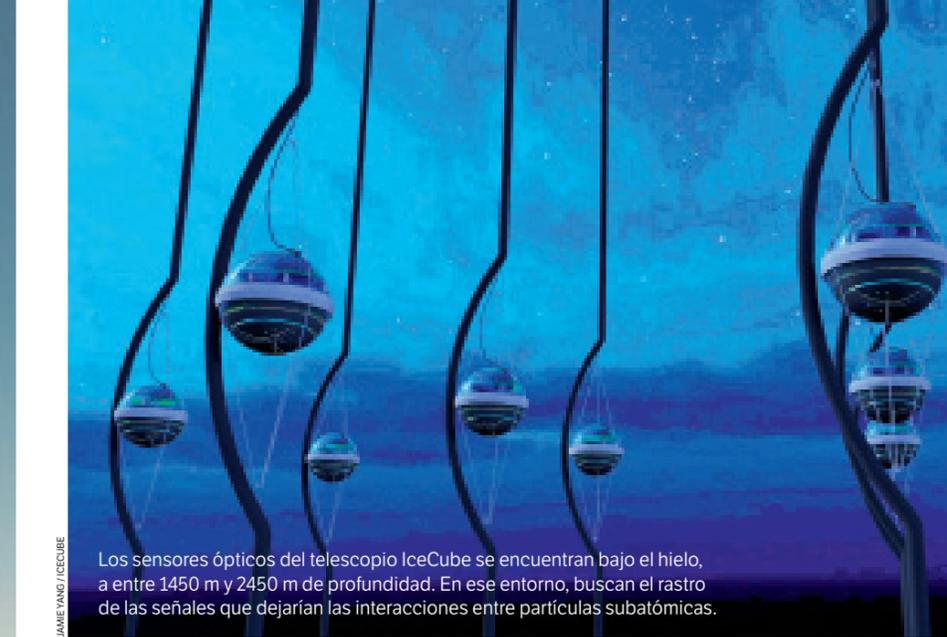
Los sensores ópticos del telescopio IceCube se encuentran bajo el hielo, a entre 1450 m y 2450 m de profundidad. En ese entorno, buscan el rastro de las señales que dejarían las interacciones entre partículas subatómicas.
