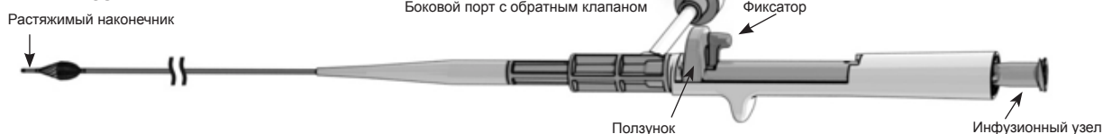
РИСУНОК 1. ИНФУЗИОННАЯ СИСТЕМА SUREFIRE
