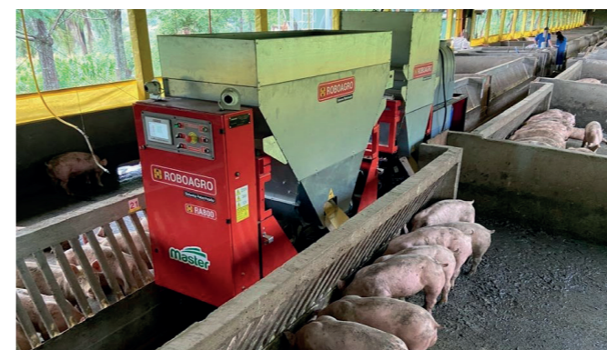
Alimentador automático de suínos analisa cada animal e fornece a quantidade ideal de ração - Foto: Reprodução Roboagro
