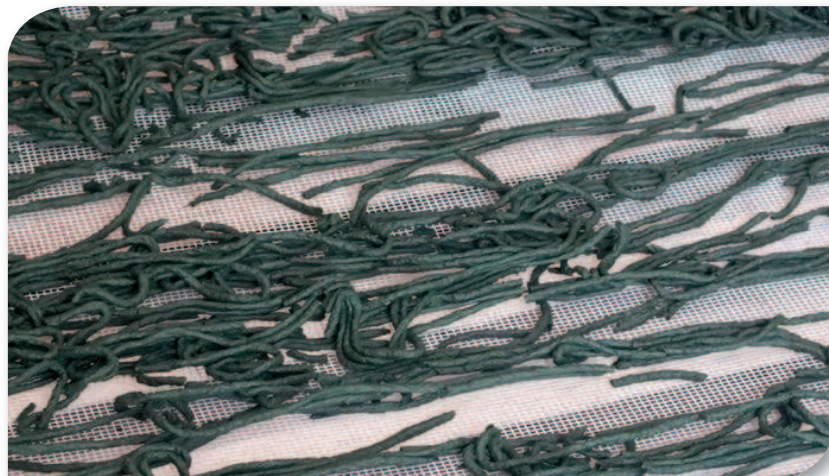
La spiruline est séchée à basse température dans des armoires utilisant également la chaleur du méthaniseur.
