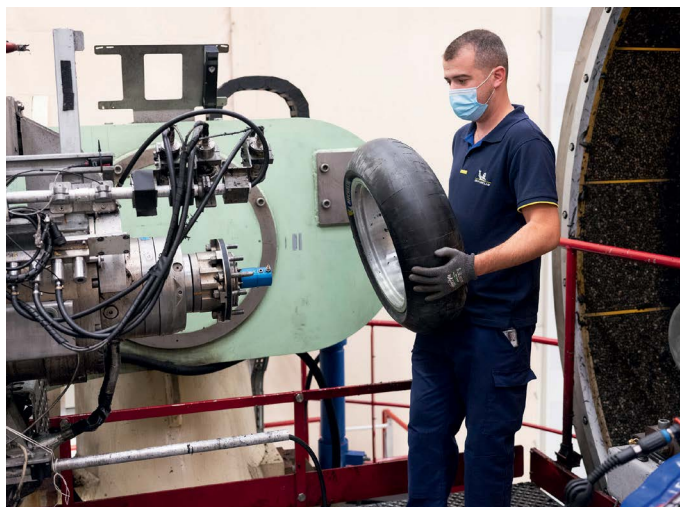
Ci-dessus, Anthony Scaggion, testeur maison, place un pneu dans la centrifugeuse, surnommée «le volant», qui va permettre d'en tester la résistance. A droite, un prototype de pneu sans air.
