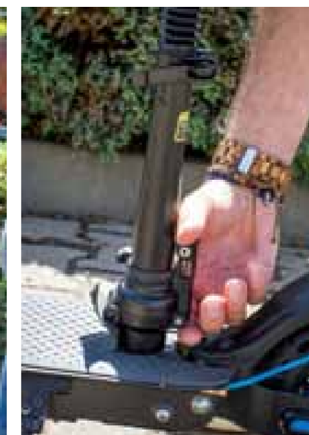
... poté uvolníme pojistku na základně podvozku a sklápíme.
