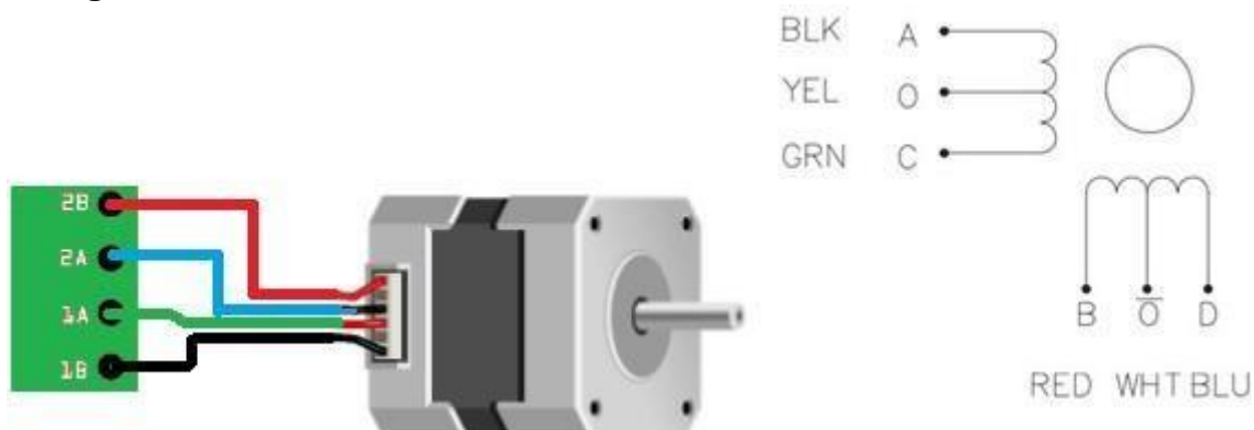
Figura 11 – Motor NEMA 17 conectado ao A4988
