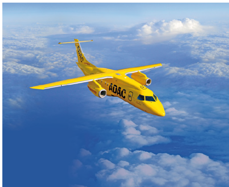
Abb. 6: Dornier 328Jet: Bis zu sechs liegende Patienten kann das Ambulanzflugzeug auf der Kurz- und Mittelstrecke transportieren. (Foto: ADAC)
