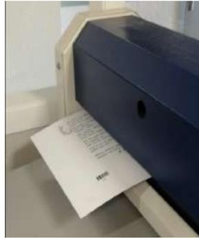
À gauche, la couverture est collée contre les bordures, la main donne le mouvement pour que celle-ci s'engouffre dans le rouleau d'entraînement. Ce dernier enclenche le rouleau d'embossage situé sous le capot bleu sur l'image de droite. La couverture est ensuite éjectée dans le bac de réception.
