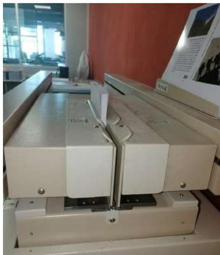
*Vu de côté, la photo de gauche montre le bloc de texte entrain de se faire entailler par la lame de grecquage. Pendant ce temps, on installe la couverture sur la station d'emboitage. Lorsqu'elle est bien centrée, on appuie sur start pour que la pince revienne. Sur la photo de droite, la station d'emboitage est remontée contre le bloc de texte et la colle se répand dans le dos.*
